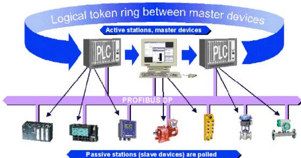
Figura 104. Configuração PROFIBUS com 3 estações ativas (mestres) e 7 estações passivas (escravos). Os 3 mestres formam um anel lógico de token
